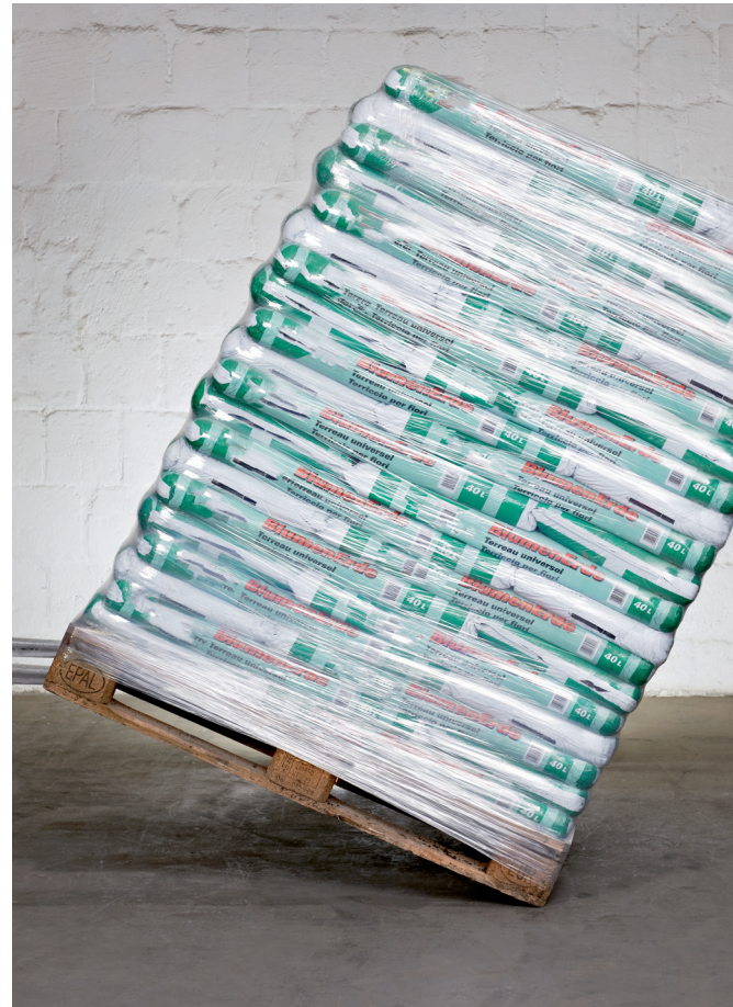
100 % Ladeeinheitenstabilität beim 30°-Kipptest
