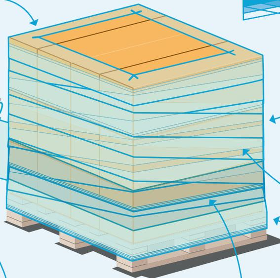
Bei Lagenübergängen im unteren Bereich der Ladeeinheit, sollten **Stützwicklungen** ergänzt werden.
